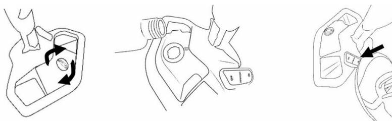
Podczas czyszczenia powierzchni zanieczyszczonej tłuszczem, olejem itp. można również dodać do gorącej pary środek czyszczący w celu zwiększenia efektu czyszczenia. Odkręcić „korek zbiornika środka czyszczącego”, wlać do niego rozcieńczony środek czyszczący, a następnie ponownie zamknąć zbiornik. Wciśnij przycisk spustu roztworu czyszczącego do pozycji ON.
