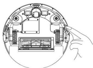
**Konektory nabíjacej stanice:** Odpojte napájanie a raz za mesiac očistite kontakty mäkkou suchou handričkou.
