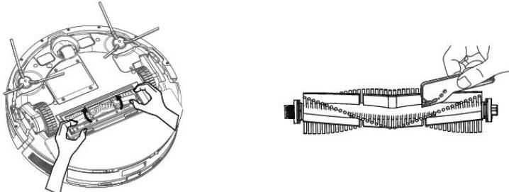
Vjměte hlavní středový čistící kartáč stisknutím obou úchytek na krytu kartáče. K odstranění vlasů zamotaných do hlavního kartáče použijte čisticí nástroj. Udržujte středový čistící kartáč bez většího množství vlasů, prachu, bavlny apod. Zkontrolujte dle intenzity znečištění, minimálně jednou týdně, oba boční čistící kartáče společně s otvorem pro nasávání vzduchu a odstraňte z nich namotané vlasy a další nečistoty.
