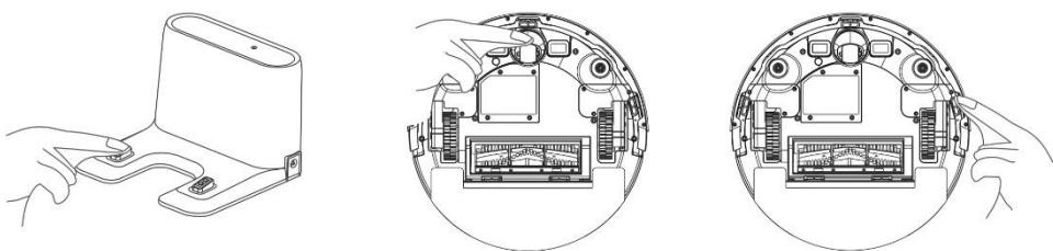
**Konektory nabíjecí stanice:** Odpojte napájení a vycistěte kontakty 1x za měsíc jemným, suchým hadříkem.
