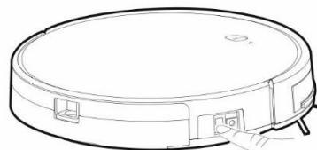
**Zapnutí:** přepněte spínací tlačítko do pozice ON (I)
