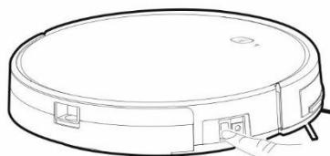
**Pornire:** comutați butonul de pornire/oprire în poziția **ON ( I )**
