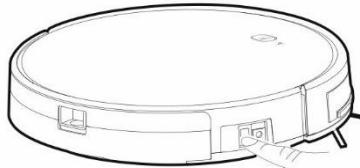
**Zapnutie:** prepnite spínacie tlačidlo do pozície ( 1 )
