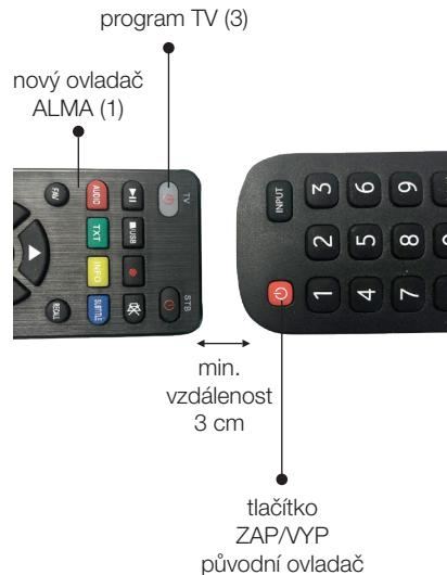
3. Na programovatelném ovladači ALMA (1) stiskněte a držte tlačítko TV (3) po dobu 5 vteřin. LED dioda přestane blikat a stabilně svítí a ovladač spustí nahrávací mód.
